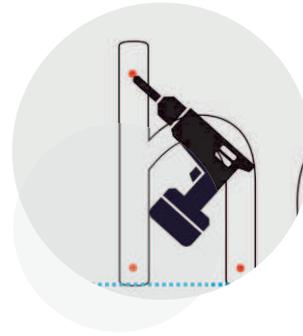
**3** Cuando tengas todas las perforaciones realizadas retira la plantilla de papel y rellena las perforaciones con el adhesivo tipo silicona.
